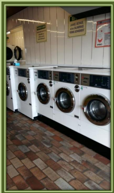
les machines peuvent supporter des masses de linges différentes . Les masses sont de 6,5 kg, 13,5 kg et 16,5 kg.
